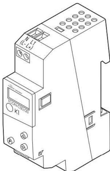
nVent RAYCHEM TCON-CSD/20 — компактный электронный термостат для простого регулирования (включение/выключение) цепи обогрева. Температура измеряется датчиком температуры и отображается на ЖК-дисплее. Состояние реле управления отображается индикатором на панели термостата. Программирование и управление термостатом осуществляется с помощью трех клавиш на передней панели.
